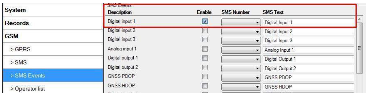
Рис. 34. Конфигурирование оповещений по SMS о событии на цифровом входе 1.
