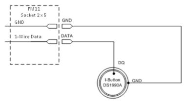
Figure 9 I-Button DS1990A connection scheme
